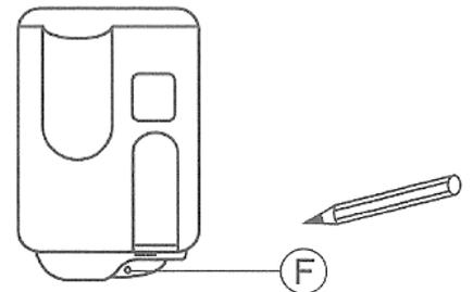
③ Retire o aparelho e fure na parede na marca. Insira a bucha no buraco F.
