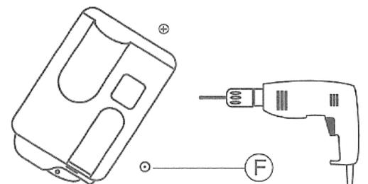
④ Pendure o aparelho na parede e aparafuse.
